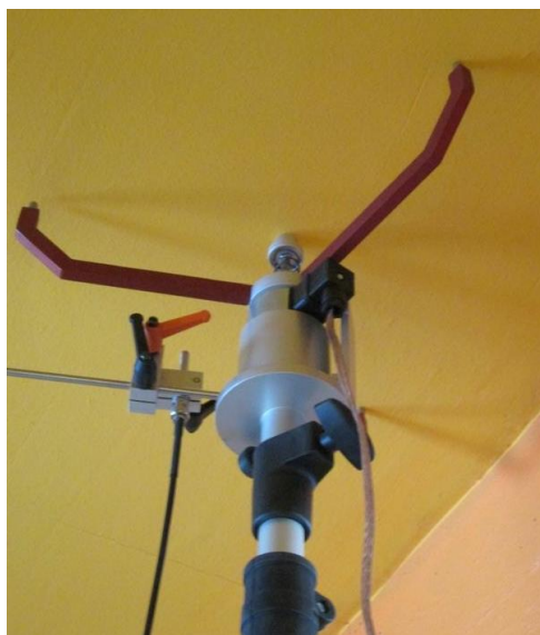
Figura 2 Attrezzatura MAST-Test (con particolare di attuatore e microfono)
