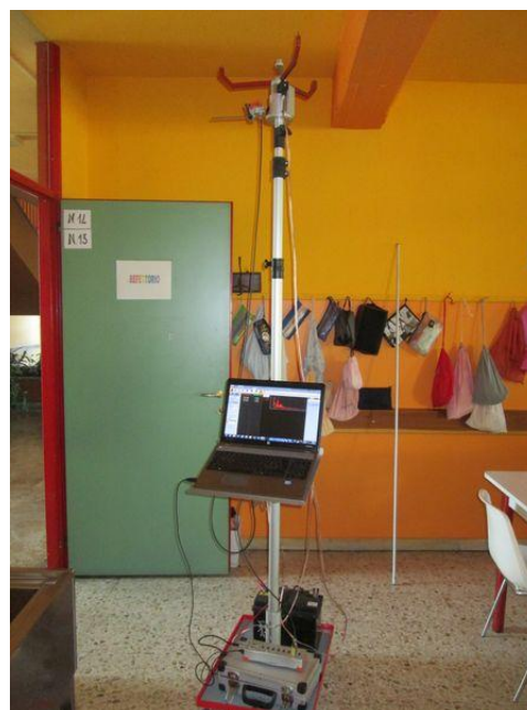
Figura 2 Attrezzatura MAST-Test (con particolare di attuatore e microfono)
