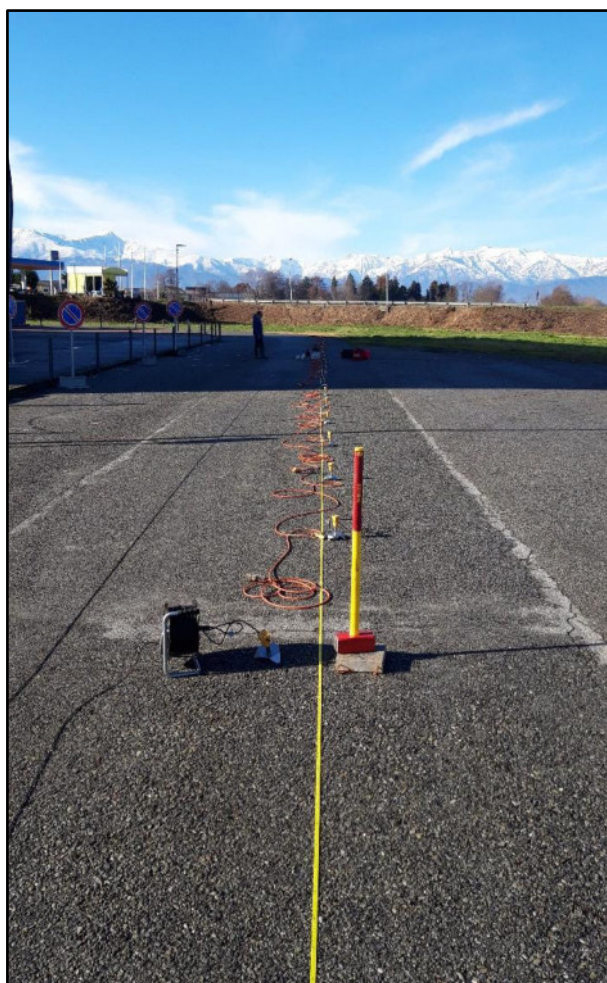
Ripresa fotografica n.1: stendimento sismico MASW M1
